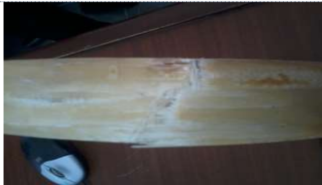
Fig 15 Failure due to pure tensile load
